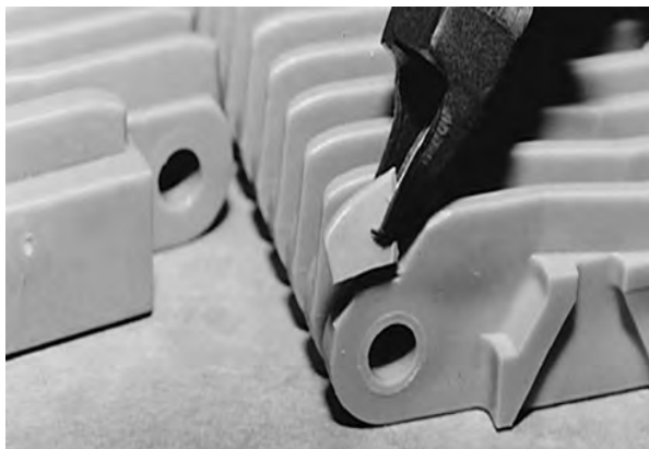
图 47: 切割最外侧突肋
