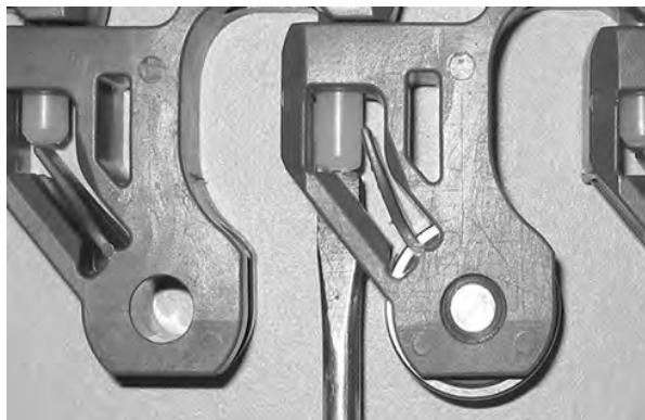
图 278: 将销杆推过固定件
