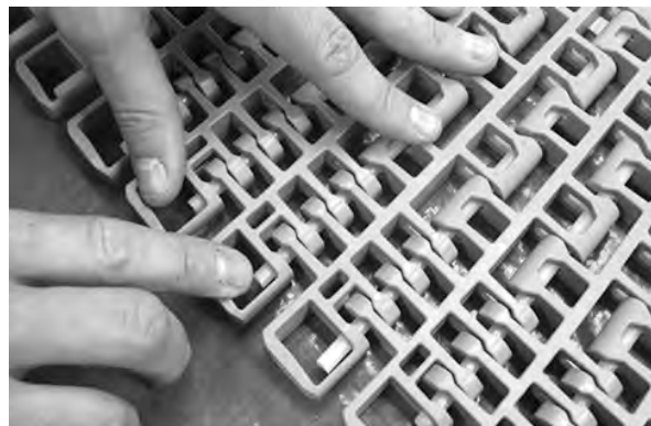
图 339: 确保销杆推过固定件
