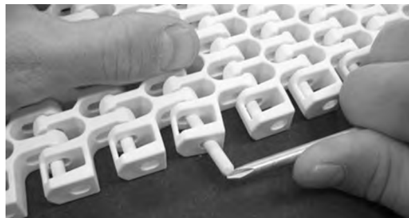
图 288: 将销杆推过固定件
