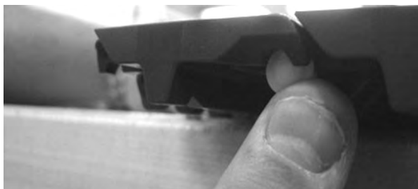
图 69: 将销杆推过固定件
