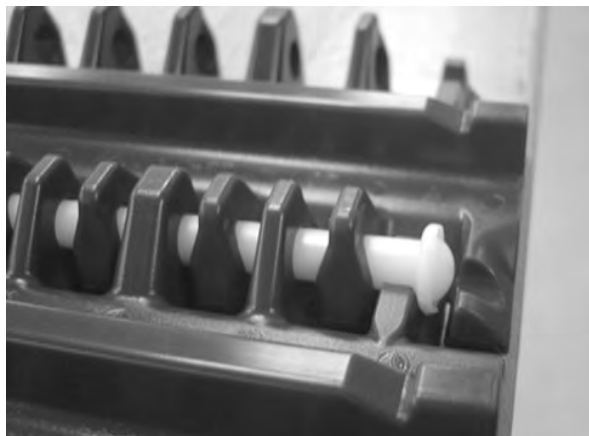
图 70: 确保销杆推过固定件
