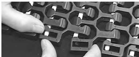
图 307: 推动销杆穿过传送带侧边并将销杆上方的齐边卡锁
