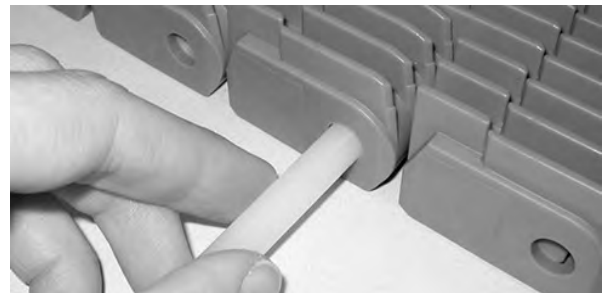
图 218: 将销杆从传送带中顶出
