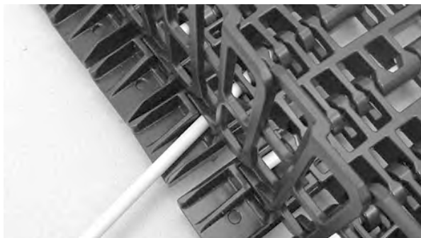
图 364: 将销杆插入铰链中
