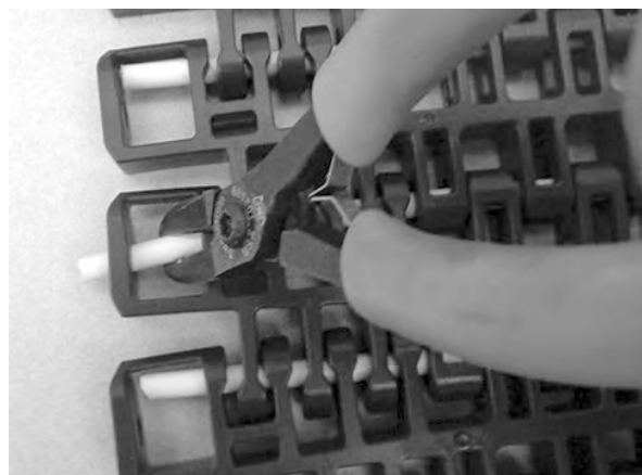
图 357: 将销杆推过固定件
