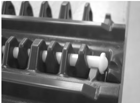
图 99: 确保销杆推过固定件
