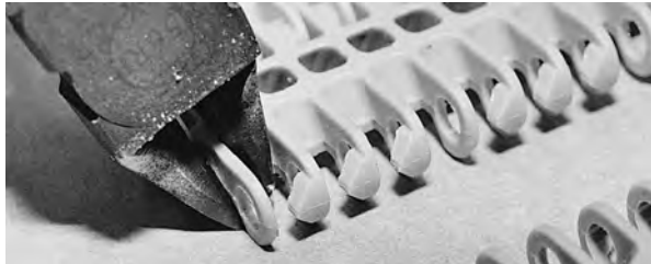
图 26: 剪去最外侧的链节
