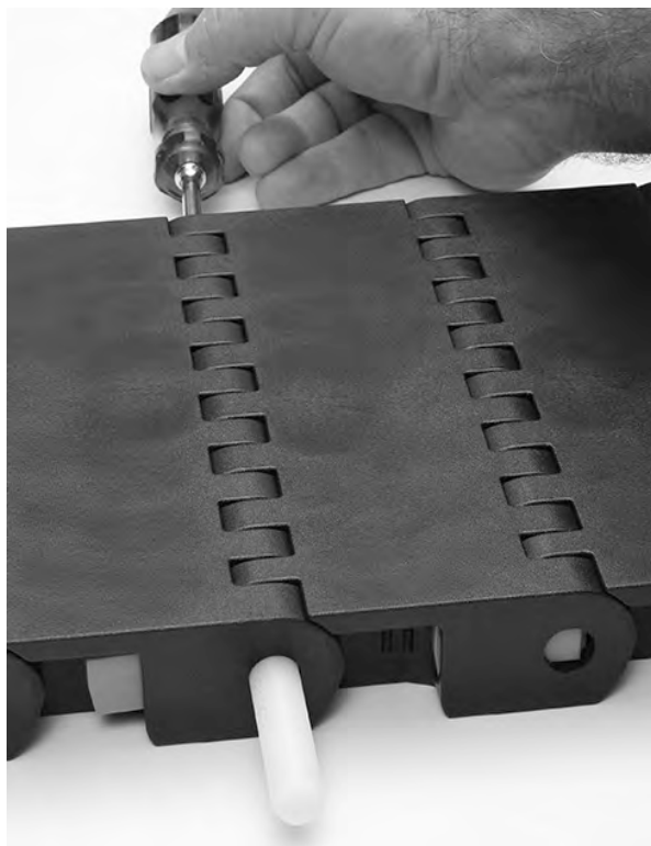
图 263: 将销杆推出传送带
