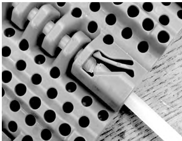
图 85: 将销杆推过固定件
