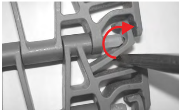
图 249: 转动螺丝刀将固定件按开
