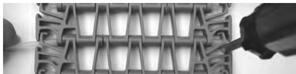
图 250: 将销杆推出传送带
