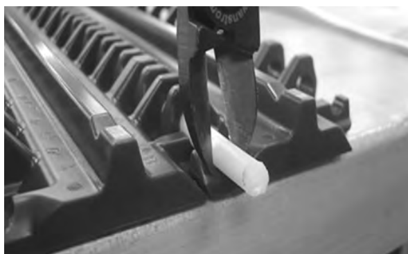
图 72: 将销杆从传送带中顶出
