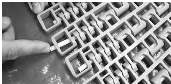
图 338: 将销杆推过固定件
