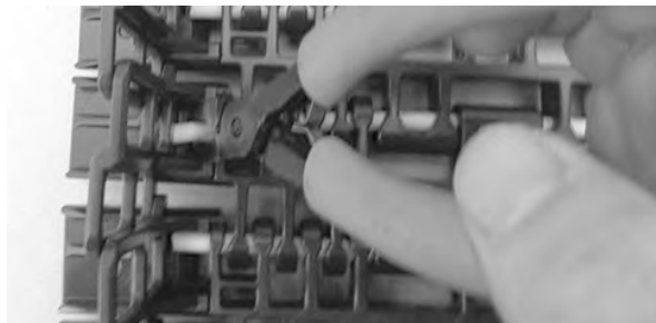
图 367: 将销杆推过固定件
