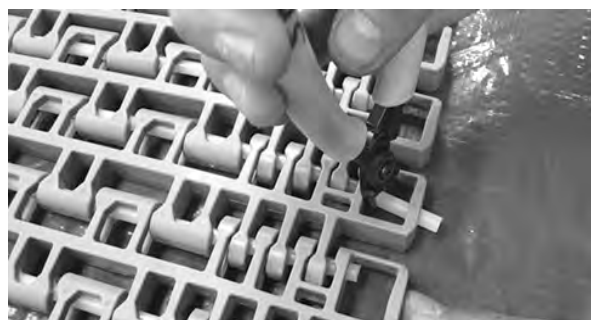
图 340: 将销杆从传送带中顶出
