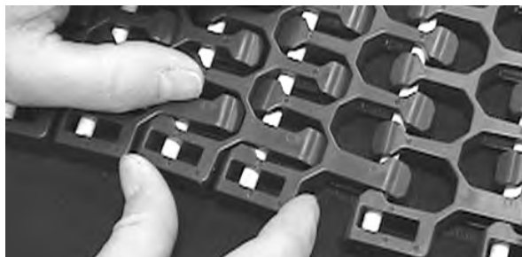
图 308: 确保销杆完全插入
