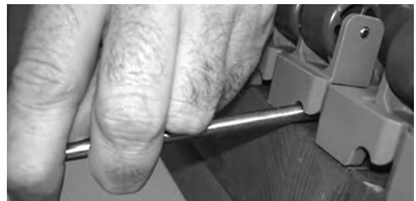
图 193: 将钢制销钉插入铰链中
