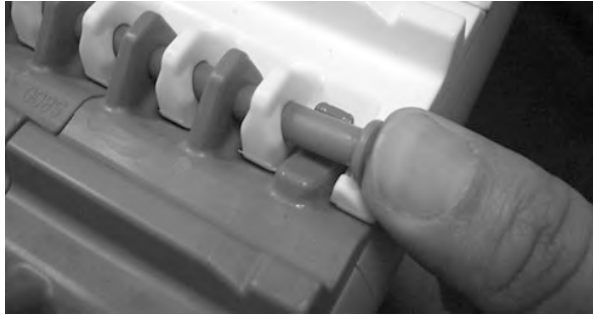
图 77: 将销杆推过固定件
