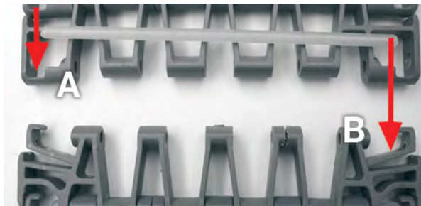
图 251: 将销杆固定件定位
