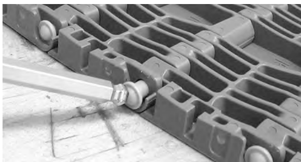
图 267: 将固定钉推过固定件
