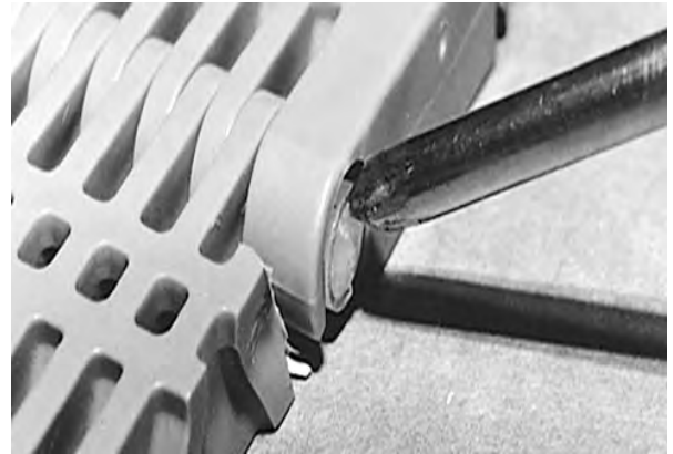
图 48: 将销杆头推过固定件
