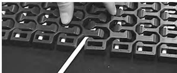
图 304: 将销杆插入铰链中
