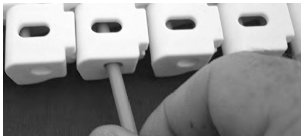
图 282: 将销杆插入铰链中
