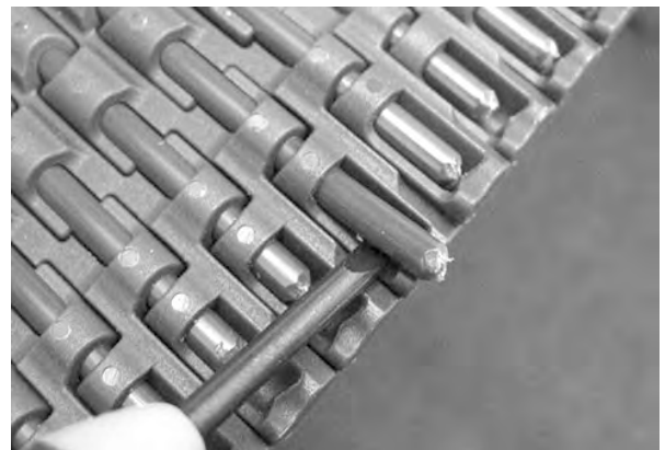
图 56: 使销杆向上脱离固定件
