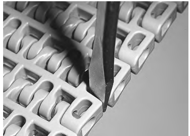
图 138: 将销杆推过固定件
