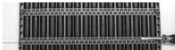
图 239: 将销杆推出传送带
