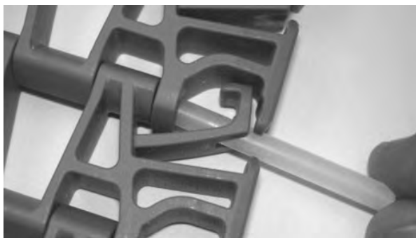
图 246: 将销杆插入铰链中
