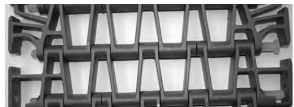
图 255: 确保销杆推过固定件
