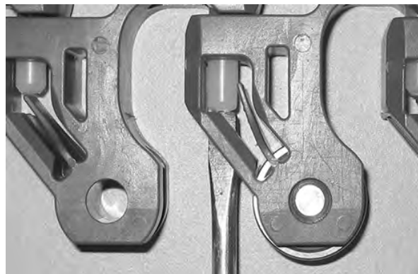
图 300: 将销杆推过固定件
