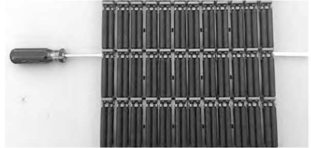
图 243: 将销杆推出传送带
