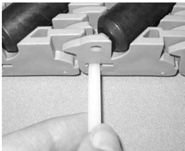
图 224: 将销杆插入铰链中
