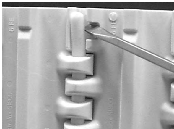
图 206: 使销杆向上脱离固定件
