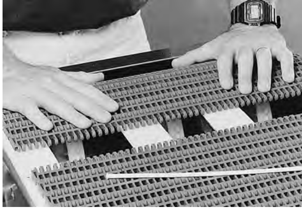
图 13: 将传送带末端推到一起
