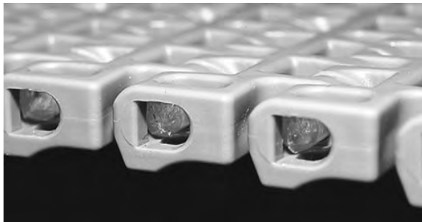
图 146: 确保销杆推过固定件
