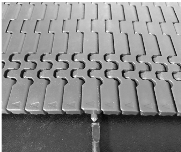
图 59: 将销杆推过固定件
