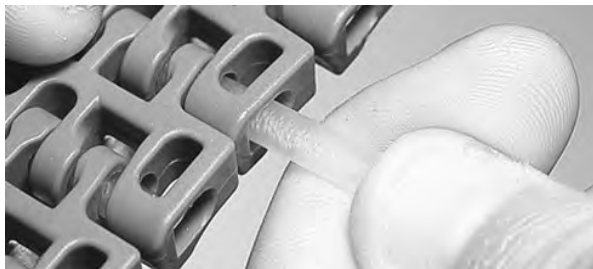
图 135: 将销杆插入铰链中
