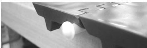
图 67: 将销杆插入铰链中
