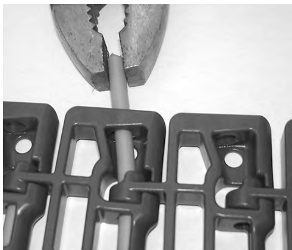
图 126: 将销杆从传送带中顶出
