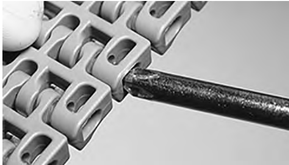
图 145: 将销杆推过固定件
