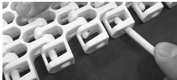
图 287: 将销杆插入铰链中
