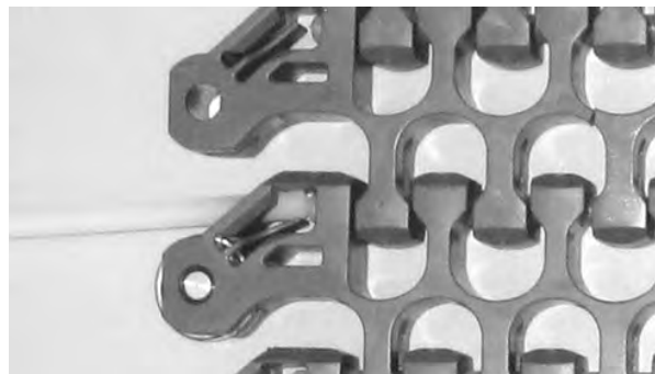
图 299: 将销杆从传送带中顶出
