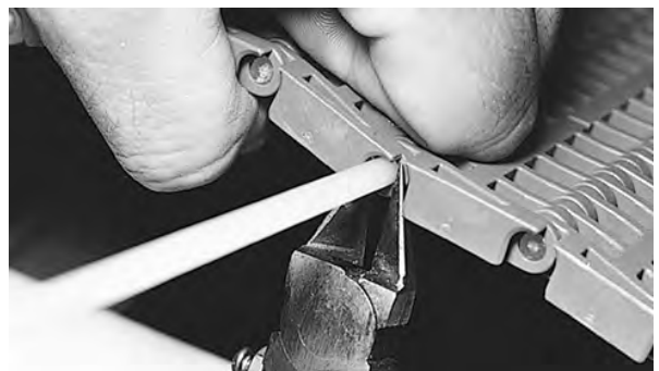
图 113: 切断销杆使之与传送带边缘平齐
