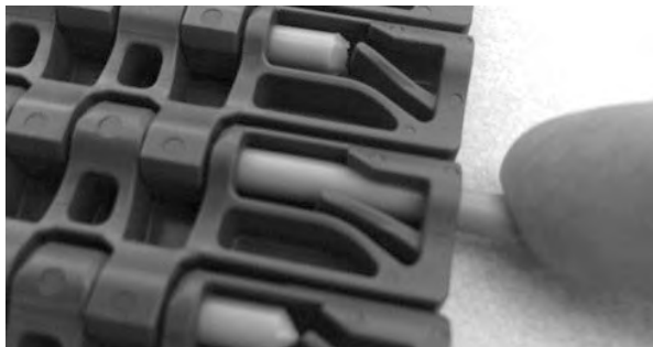
图 127: 将销杆插入铰链中
