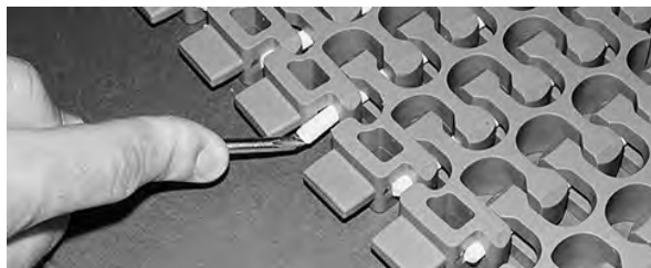
图 271: 确保销杆推过固定件
