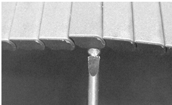
图 54: 将销杆头推过固定件
