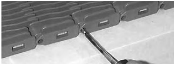
图 44: 将销杆推出传送带
