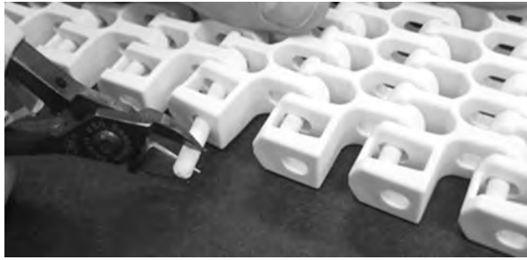
图 291: 将销杆从传送带中顶出
