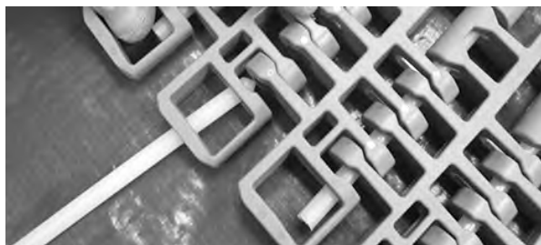
图 337: 将销杆插入铰链中
