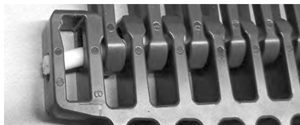
图 331: 将销杆插入铰链中
