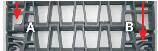
图 253: 确保销杆完全插入
