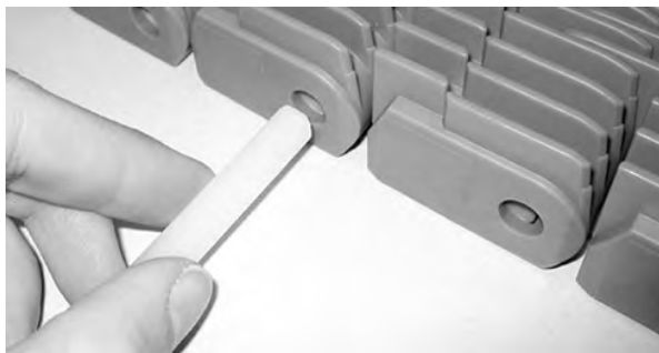
图 215: 将销杆插入铰链中
