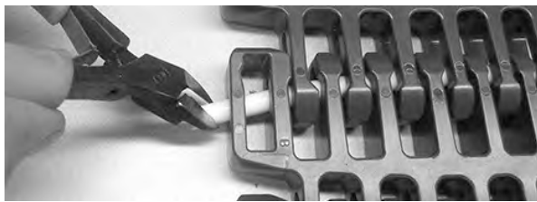
图 334: 将销杆从传送带中顶出
