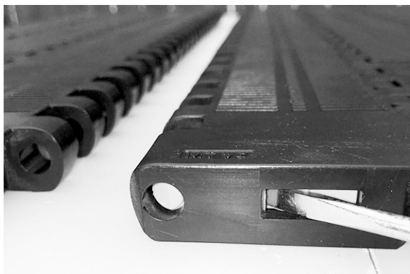
图 209: 使用螺丝刀关闭 Slidelox
