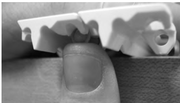
图 180: 将销杆推过固定件
