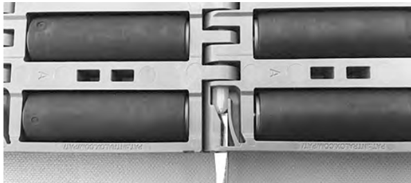
图 241: 将销杆推过固定件
