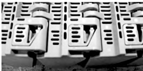
图 105: 确保固定件已关闭
