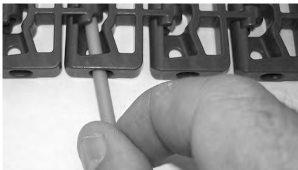
图 122: 将销杆插入铰链中
