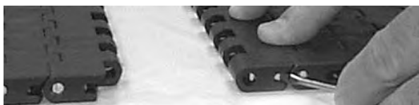
图 160: 使用螺丝刀关闭 Slidelox
