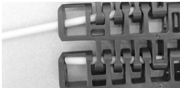
图 354: 将销杆插入铰链中
