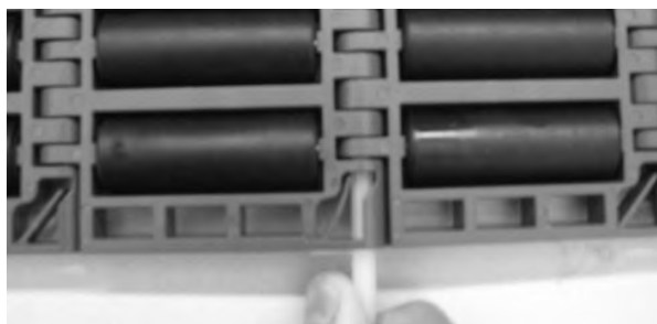
图 236: 将销杆插入铰链中
