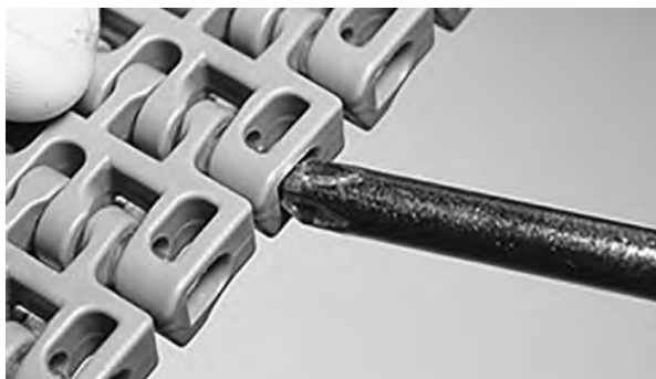
图 136: 将销杆推过固定件
