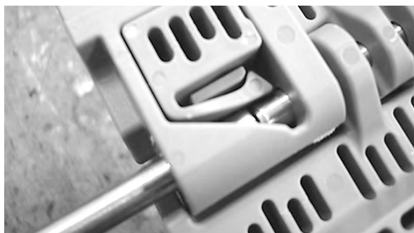
图 104: 将销杆推过固定件
