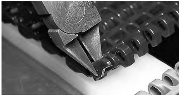
图 150: 剪掉边缘构件
