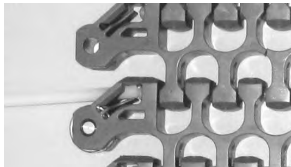
图 281: 将销杆推出传送带
