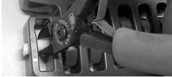
图 333: 将销杆推向一侧并穿过封闭孔
