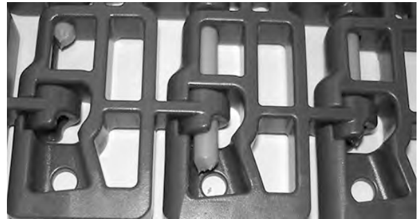
图 124: 确保销杆完全插入
