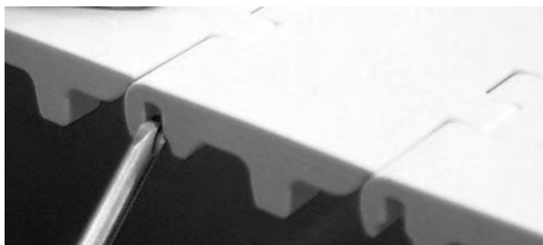
图 204: 将销杆推过固定件
