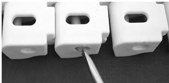
图 283: 将销杆推过固定件
