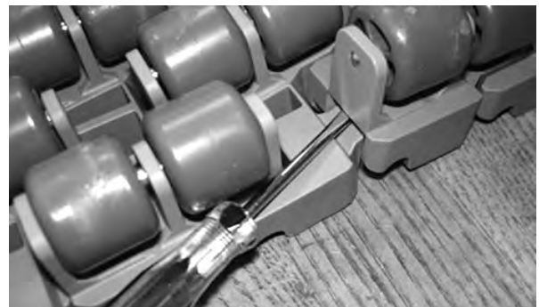
图 192: 将螺丝刀插入辊轮下方
