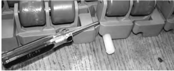
图 195: 将销杆从传送带中顶出
