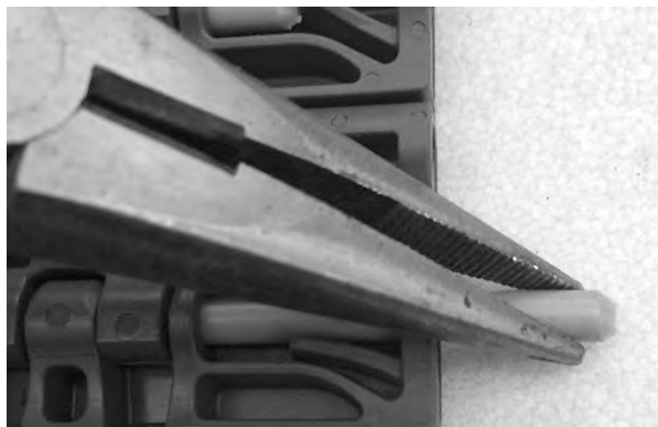
图 131: 将销杆从传送带中顶出
