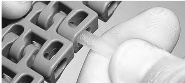
图 144: 将销杆插入铰链中
