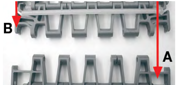
图 254: 将新段 (B) 与原始段 (A) 连接起来
