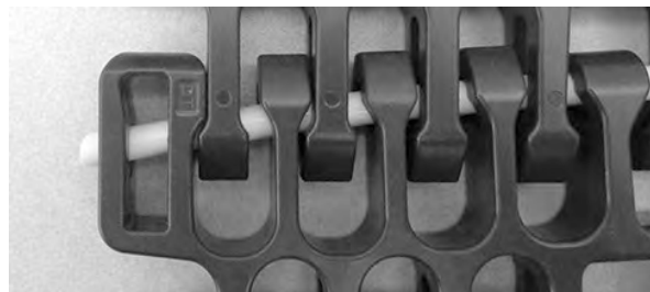
图 314: 将销杆推过固定件
