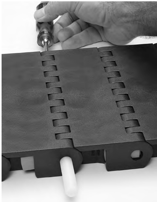
图 259: 将销杆推出传送带
