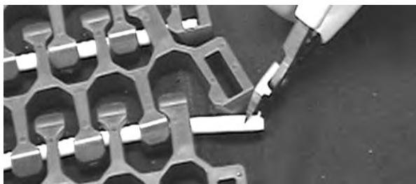
图 312: 将销杆从传送带中顶出
