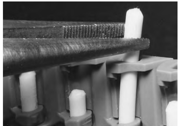
图 149: 将销杆从传送带中顶出
