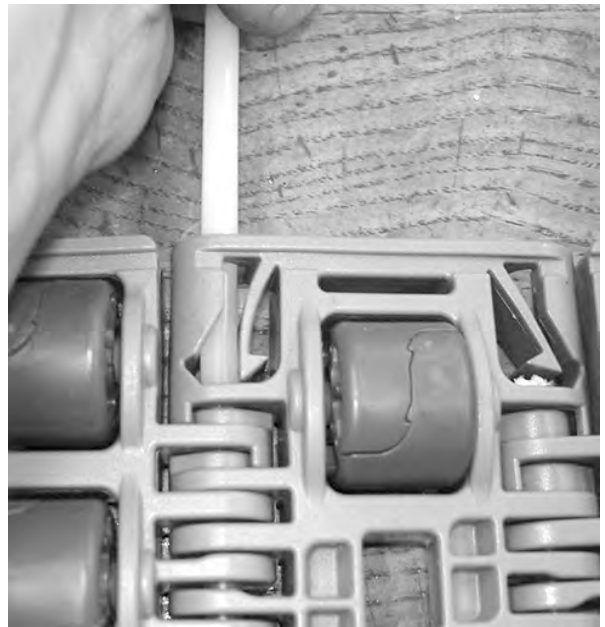
图 221: 将销杆推出传送带
