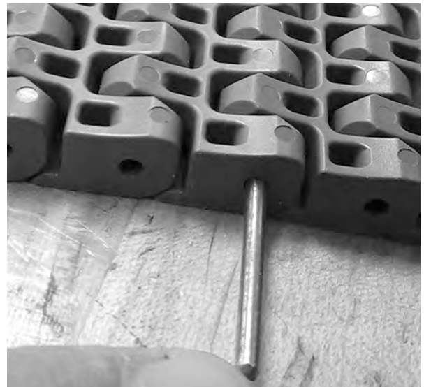
图 269: 将固定钉和销杆推出传送带
