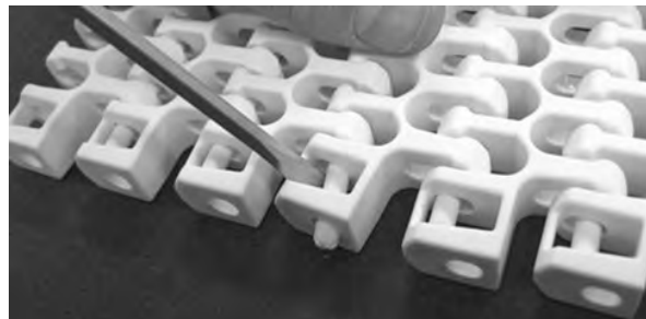
图 290: 将销杆推过固定件
