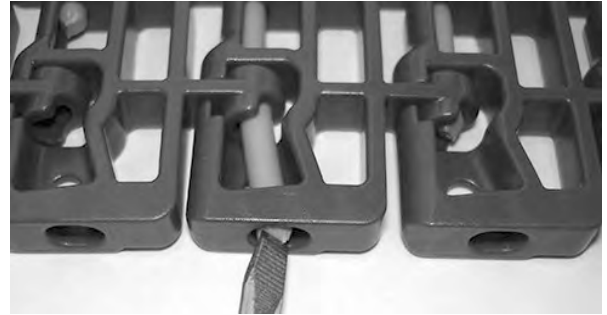
图 123: 将销杆推过固定件
