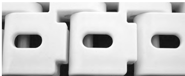
图 284: 确保销杆推过固定件
