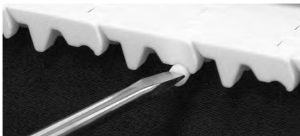
图 174: 将销杆推过固定件
