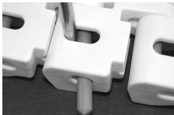
图 285: 将销杆推过固定件
