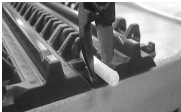
图 101: 将销杆从传送带中顶出
