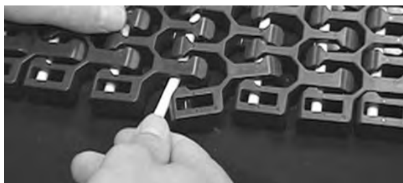
图 306: 将销杆插入铰链中
