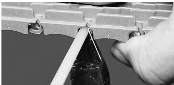
图 24: 切断销杆使之与传送带边缘平齐
