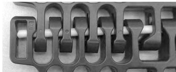
图 315: 确保销杆推过固定件
