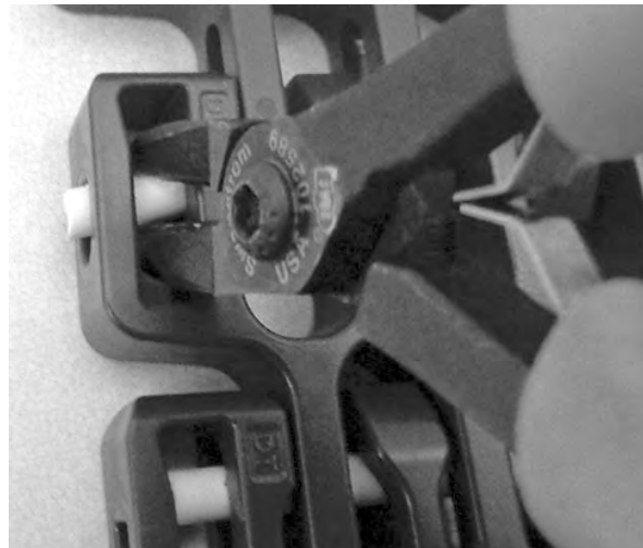
图 316: 将销杆推向一侧并穿过孔
