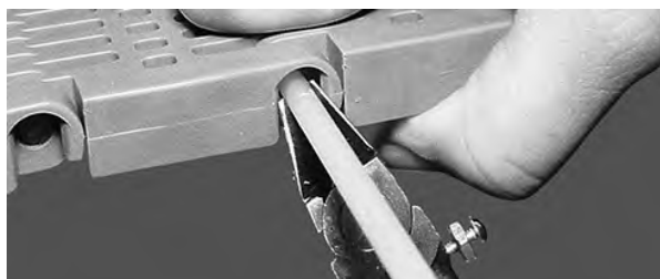
图 39: 切断销杆使之与传送带边缘平齐
