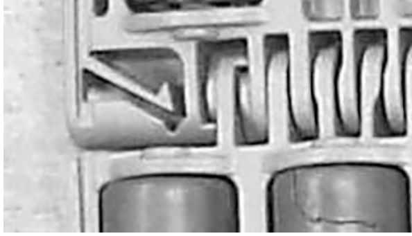
图 223: 确保销杆推过固定件
