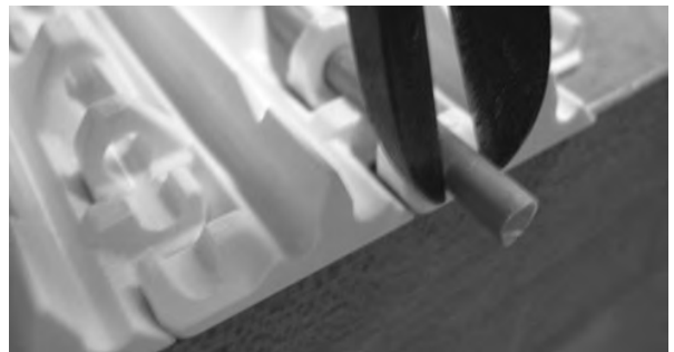
图 183: 将销杆从传送带中顶出
