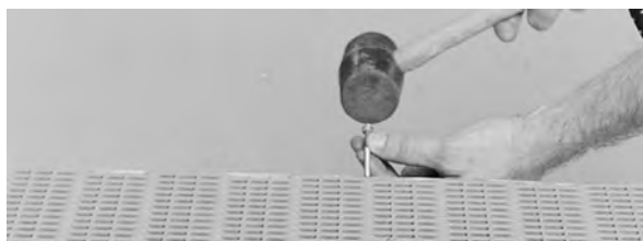
图 32: 将销杆推出传送带
